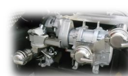
Pompa di travaso
